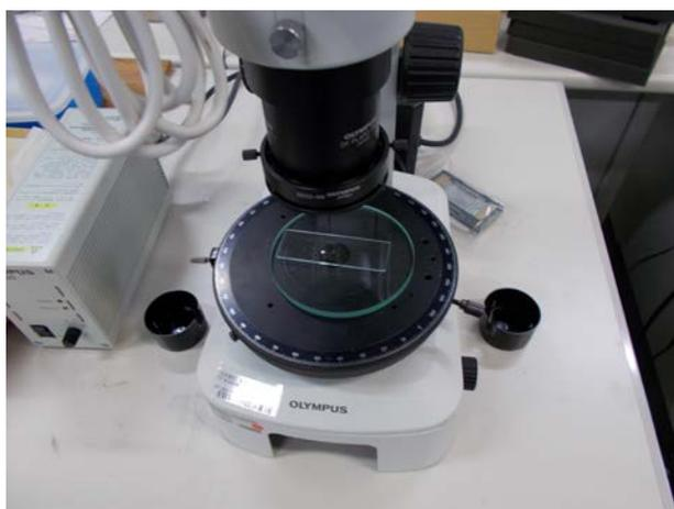
写真2 顕微鏡を用いた試料の選択、マウント
